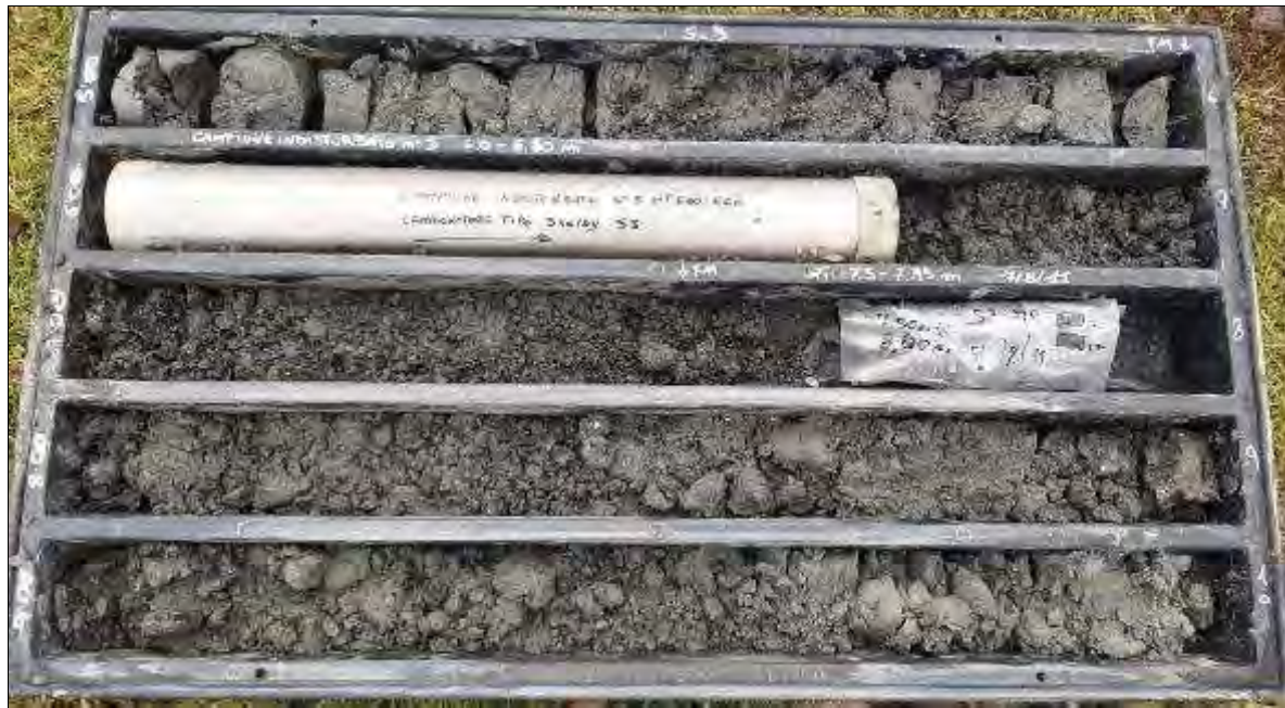
Figura 19. Sondaggio S3 cassetta 5,0-10,0 m
