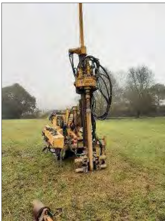
Figura 25. Piazzamento sondaggio S4 (sinistra) ed fungo protezione tubo cieco per Down Hole (destra)
