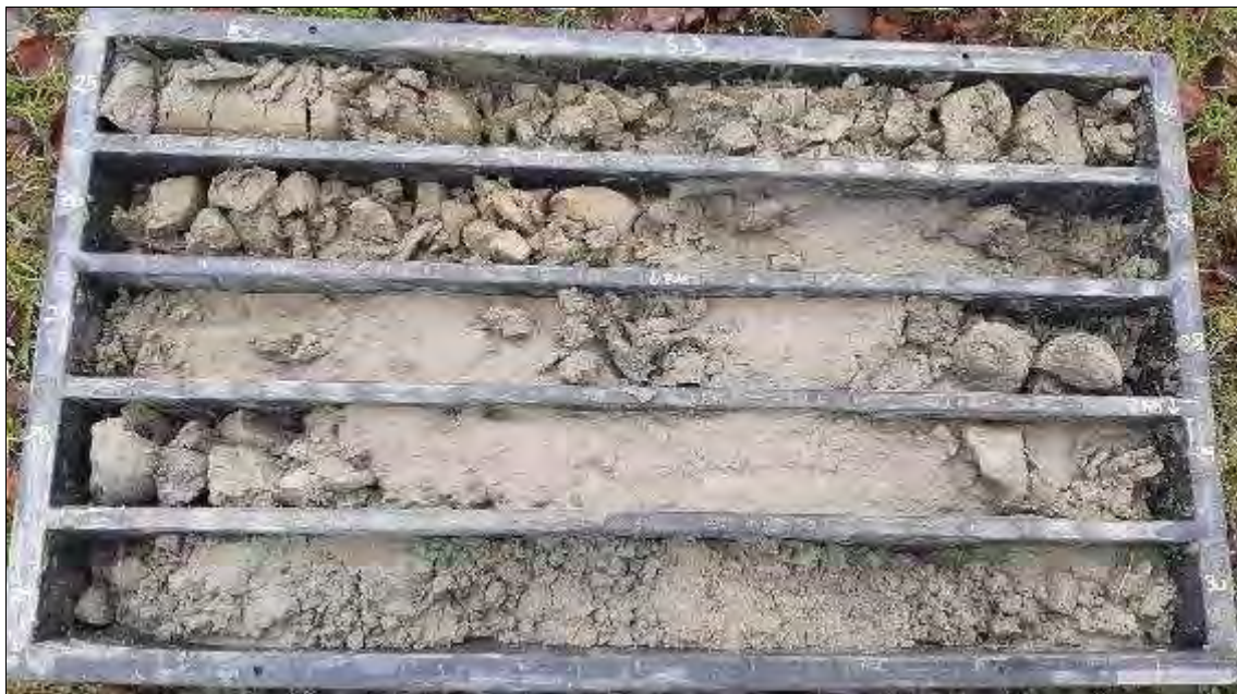
Figura 23. Sondaggio S3 cassetta 25,0-30,0 m
