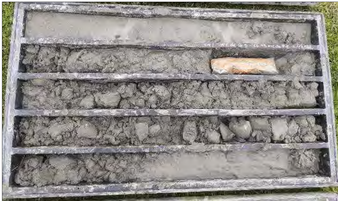
Figura 5. Sondaggio S1 cassetta 15,0-20,0 m
