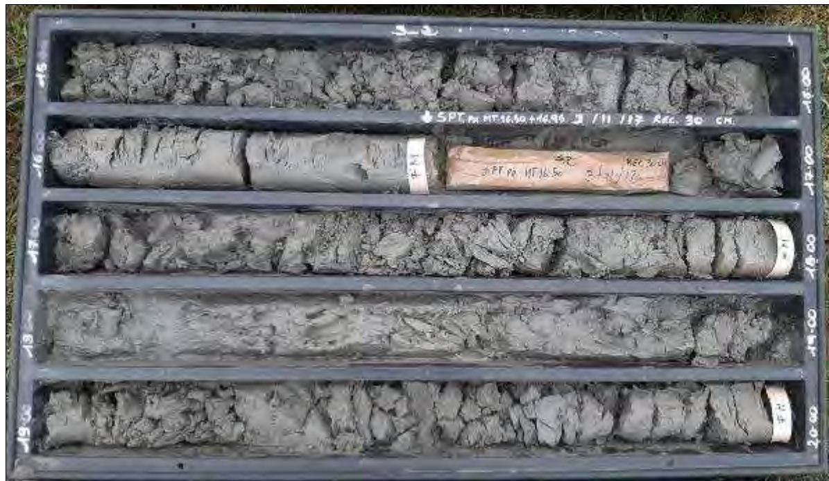
Figura 13. Sondaggio S2 cassetta 15,0-20,0 m
