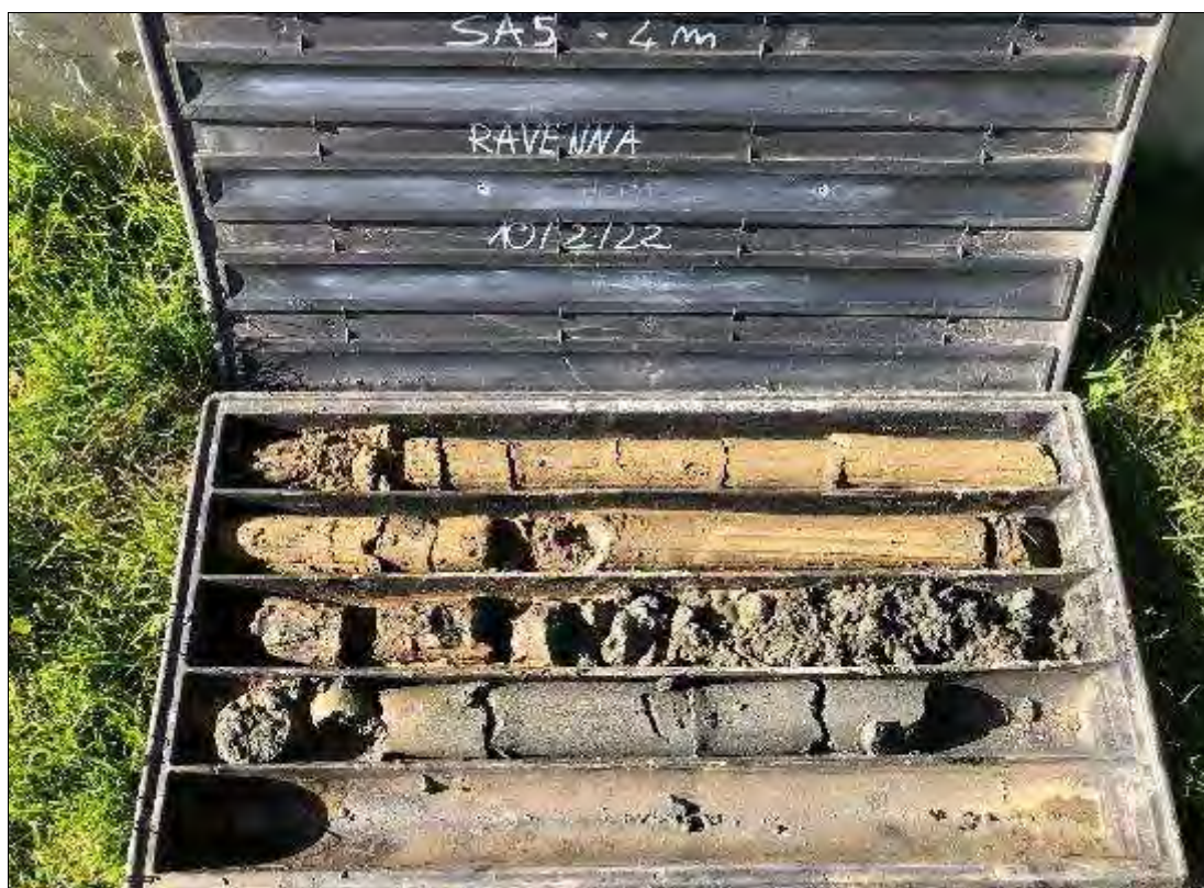
Figura 60. Sondaggio SA5 cassetta 0,0-4,0 m
