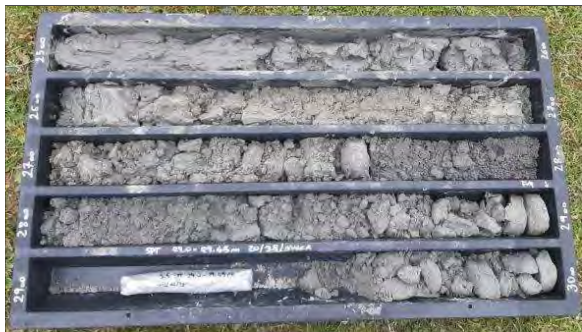
Figura 40. Sondaggio S5 cassetta 25,0-30,0 m
