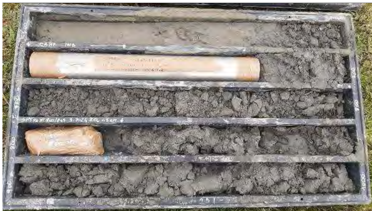
Figura 3. Sondaggio S1 cassetta 5,0-10,0 m
