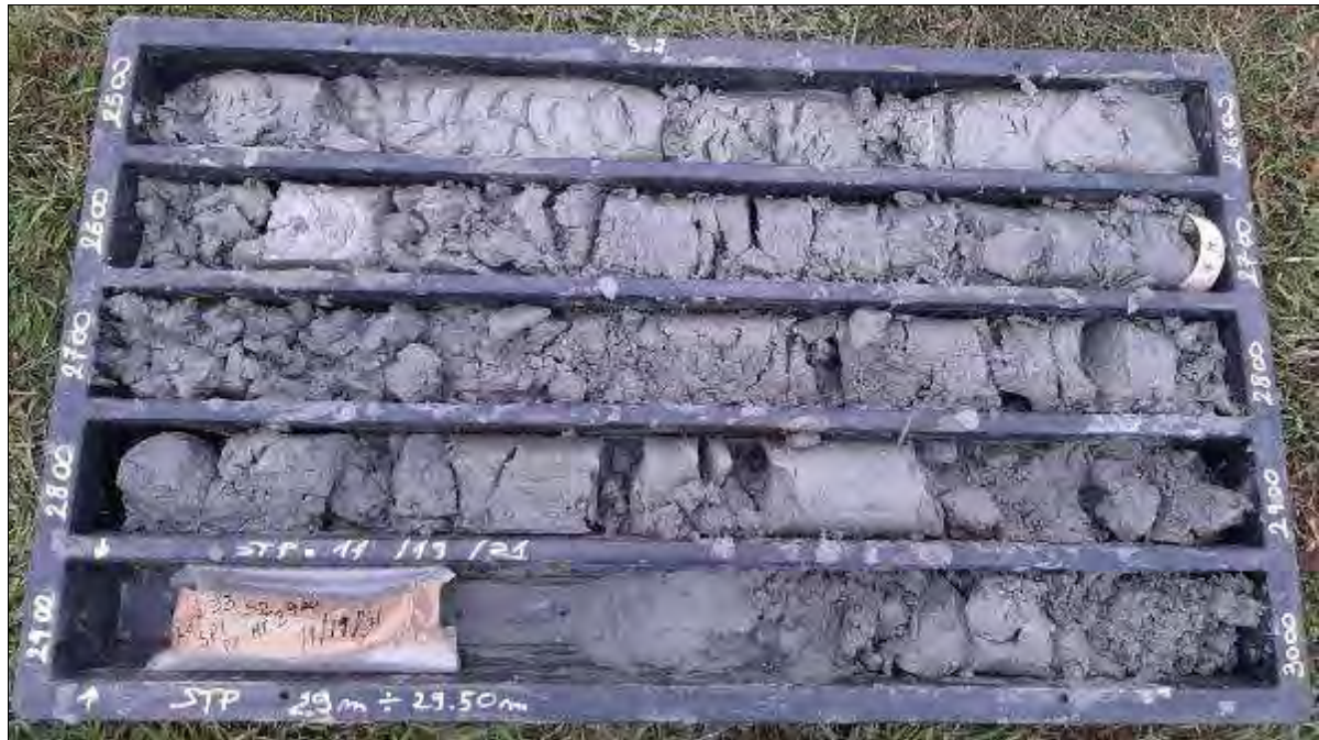
Figura 15. Sondaggio S2 cassetta 25,0-30,0 m
