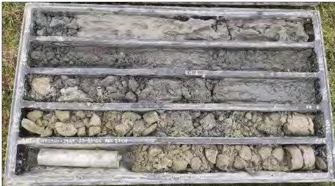
Figura 7. Sondaggio S1 cassetta 25,0-30,0 m
