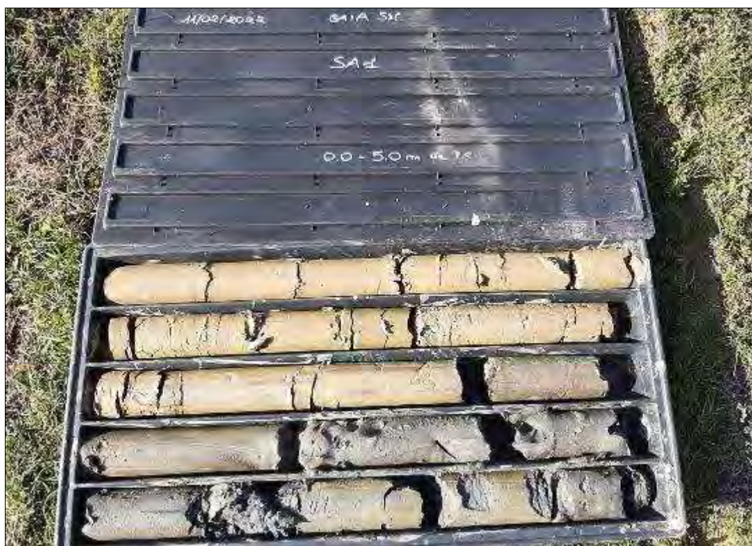
Figura 50. Sondaggio SA1 cassetta 0,0-5,0 m
