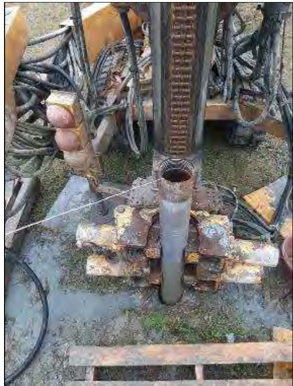
Figura 17. Piazzamento sondaggio S3 (sinistra) ed esecuzione prova Lefranc (destra)
