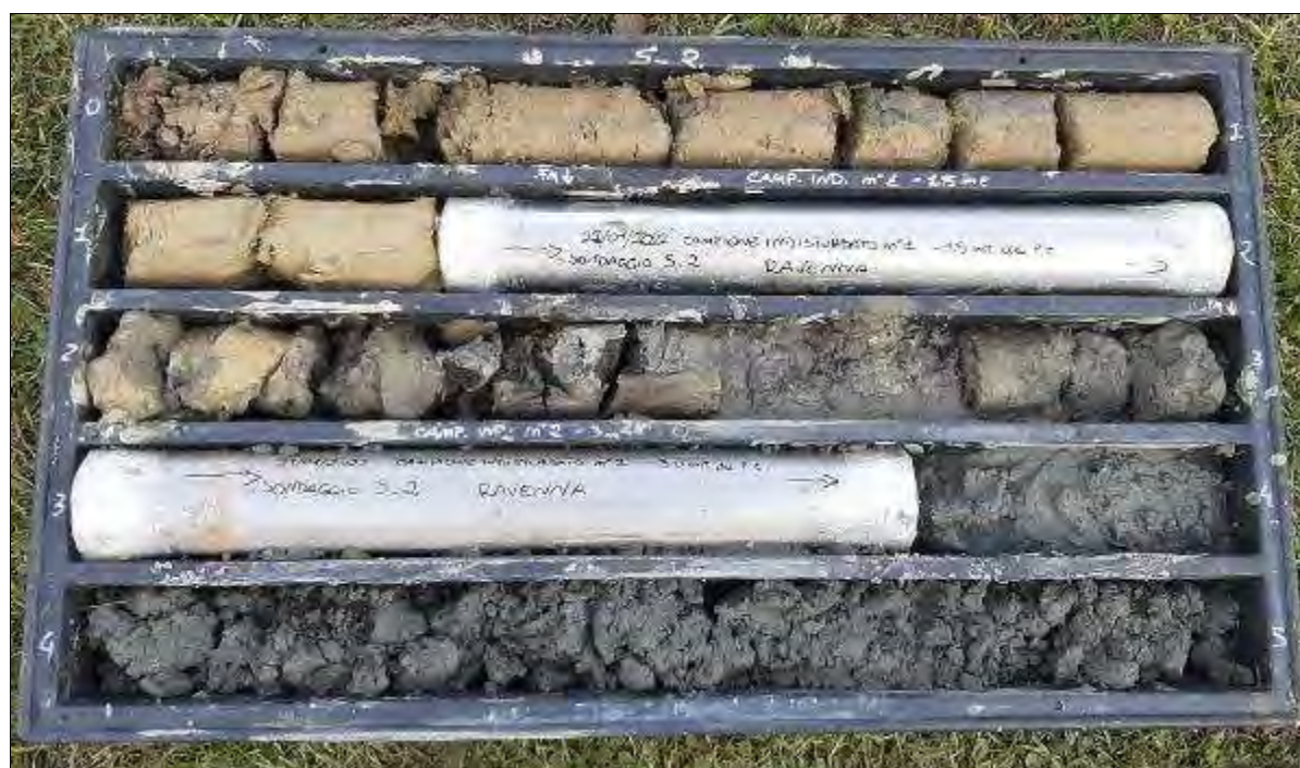
Figura 10. Sondaggio S2 cassetta 0,0-5,0 m
