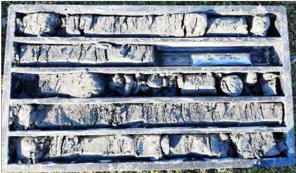
Figura 30. Sondaggio S4 cassetta 15,0-20,0 m
