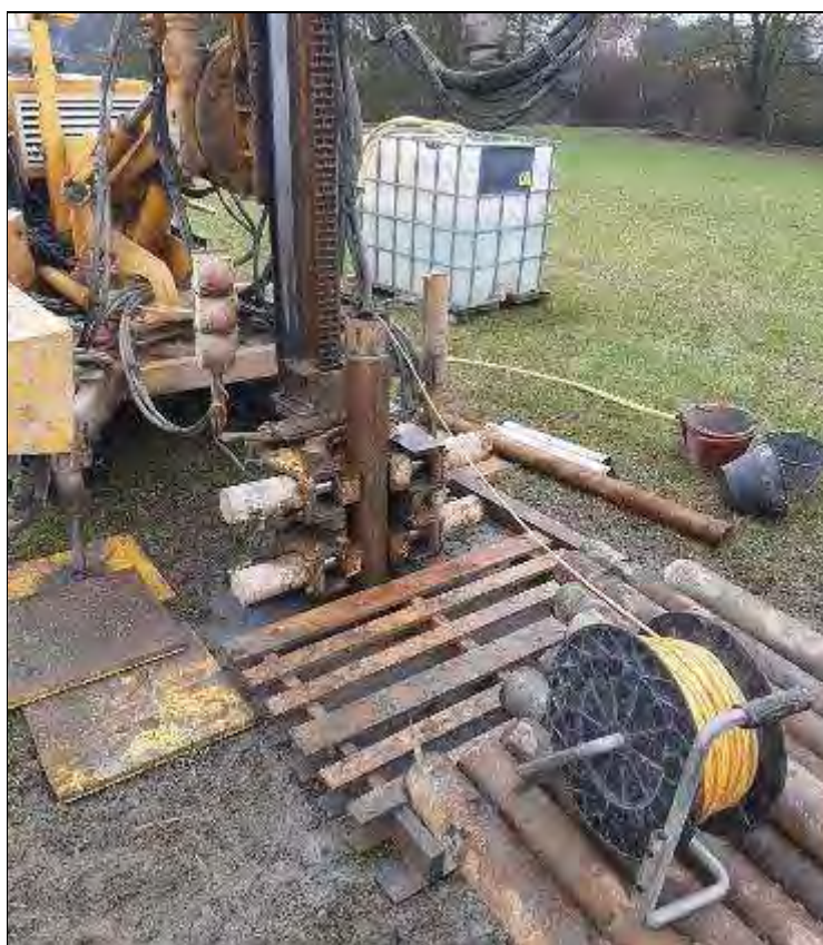
Figura 26. Prova Lefranc sondaggio S4
