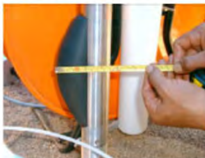
Fig. 2: sistema di ancoraggio alle pareti del foro
