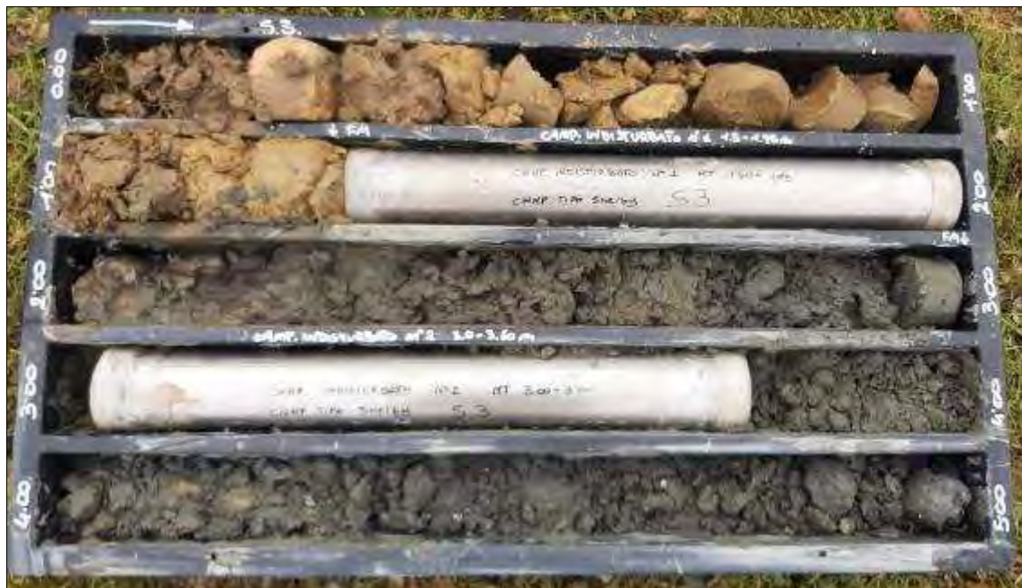
Figura 18. Sondaggio S3 cassetta 0,0-5,0 m
