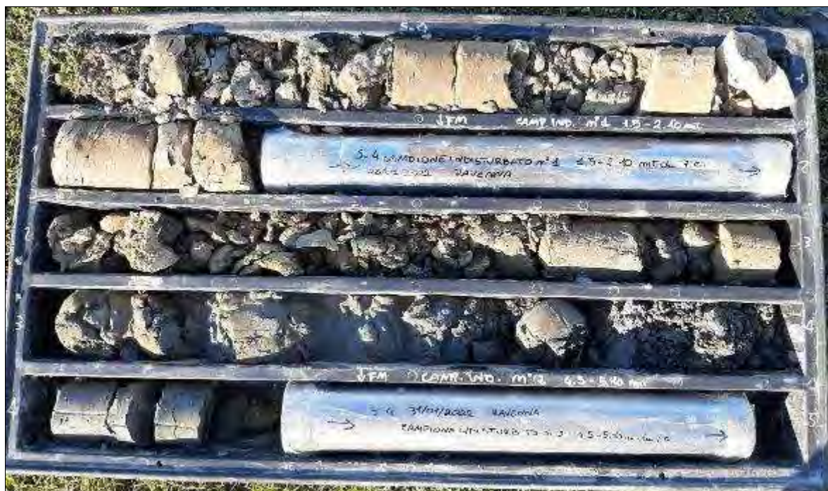
Figura 27. Sondaggio S4 cassetta 0,0-5,0 m
