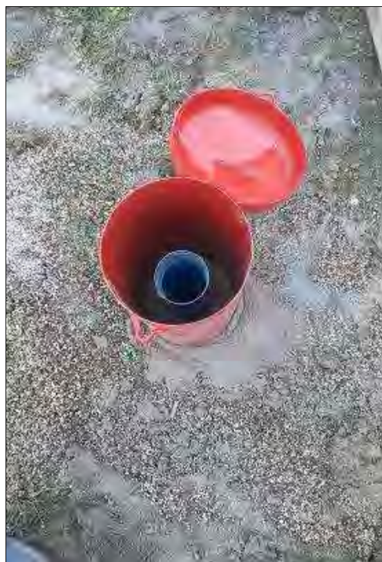
Figura 34. Piazzamento sondaggio S5 (sinistra) e piezometro finito (destra)
