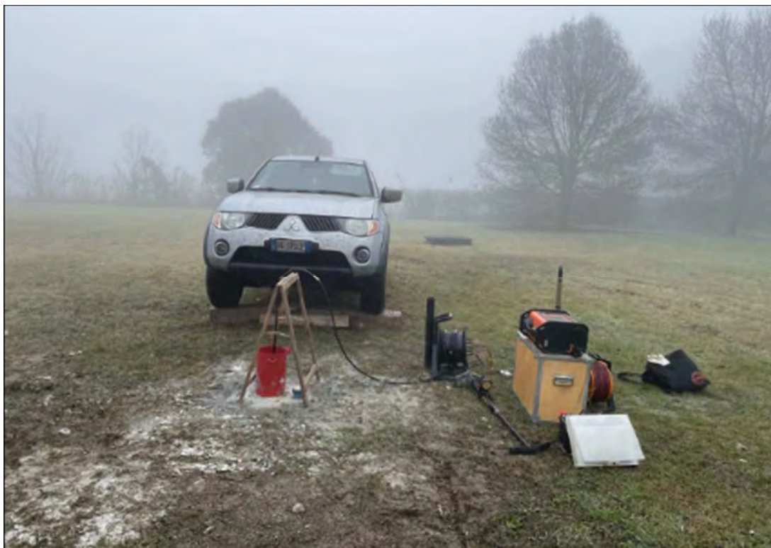
Figura 48. Esecuzione prova sismica Down Hole in S4
